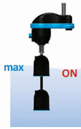
A maximális töltési magasság elérésekor a mágneses érintkező zár, és a szivattyú megkezd a tartály ürítését.
