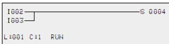
Abb. 90: Stromfluss-Anzeige
