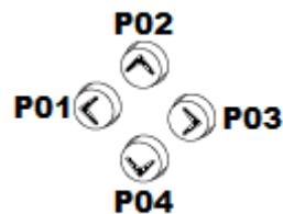
Abb. 86: Die Cursor-Tasten werden im Schaltplan als Kontakte P 01 bis P 04 verdrahtet.
